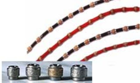
**DIATOOLS** produce cablu cu perline diamantate electrodepuse sau sinterizate pentru taierea marmurei, granitului, betonului. Se foloseste pentru extractia blocurilor din cariere, fasonarea si taierea acestora iar cablul pentru beton pentru reconstructia podurilor si a cladirilor prin debitarea elementelor din beton sau beton armat.
